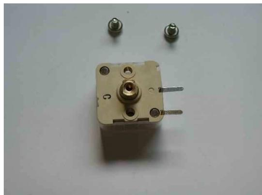
⑩ バリコンの端子を直角に折り曲げ基板の銅箔に接触するようにしてプリント板の銅箔面にバリコンを取付け、前面から付属のビスで止めます。
