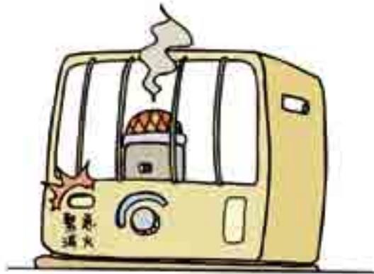
●必ず対震自動消火装置付きのものを使用する。
