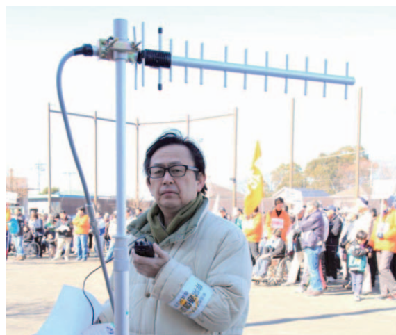
図4 拠点校に配備の1,200MHz帯アンテナ及びトランシーバ
