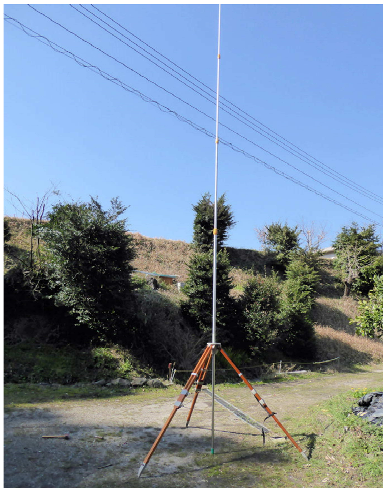
アンテナ三脚基台+ 6 m伸縮ポール
