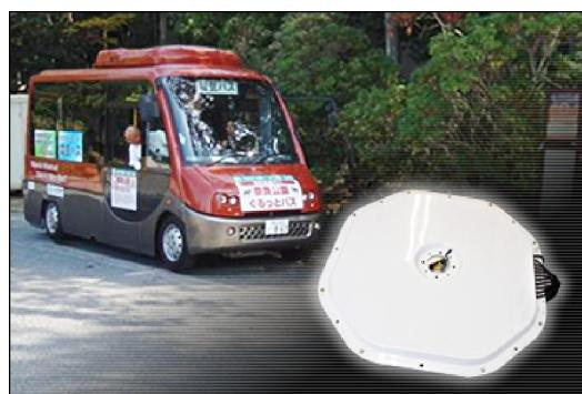
地上に設置するコイル「IPS\_30K」(30kW型)と実証実験で使われたEVバス
