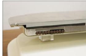
「IPT 10KJ (10kW型)の断面図。コイルの巻線が見える
