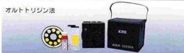
0.1~5mg/l 迄の残留塩素を9段階に測定
